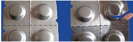
Abbildung 5: Aufreissversion (Tear-Blister). 1. Abtrennen des einzelnen Blisternapfs entlang der Perforation. 2. Aufreissen an der dafür vorgesehenen Stelle und Entnahme des Produkts. Foto: A. Ziegler
